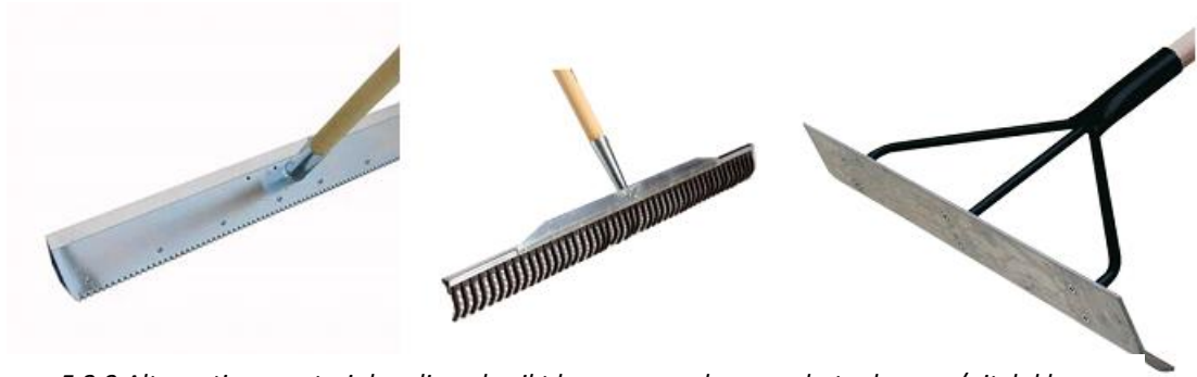
Figuur 5.2.3 Alternatieve materialen die gebruikt kunnen worden voor het schrapen/uitvlakken van de pitch.
